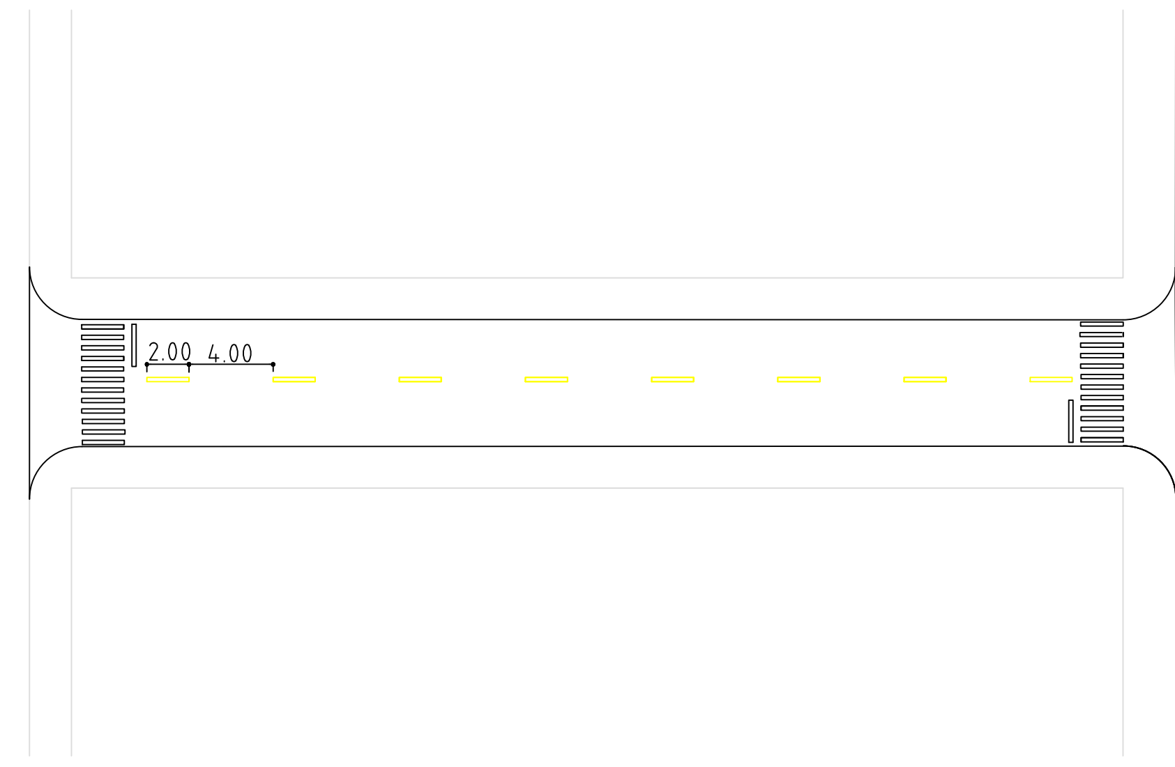
DETALHE FAIXA DIVISÃO DE FLUXO Escala: 1:50
